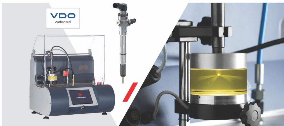
Carbon Zapp a optimisé les applications de test de ses bancs d'essais diesel, permettant désormais aux partenaires VDO DRS autorisés équipés d'unités Carbon Zapp CRU.2R de tester, réparer et coder les injecteurs EU5 Common-Rail de la marque Continental VDO grâce aux capacités de test avancées du banc pour contrôler les injecteurs mettant en œuvre un signal à contrôle électronique.
