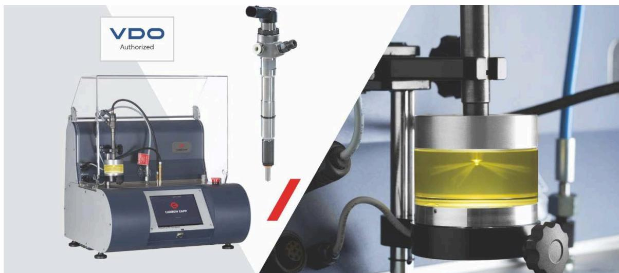
Carbon Zapp ha optimizado las aplicaciones de comprobación de sus bancos de comprobación Diesel permitiendo así a los partners autorizados VDO DRS equipados con unidades Carbon Zapp CRU.2r a poder comprobar, reparar y codificar inyectores EU5 Common-Rail de VDO Continental gracias a las avanzadas capacidades de comprobación del banco para el control de los inyectores implementando la señal Energy Controlled.
