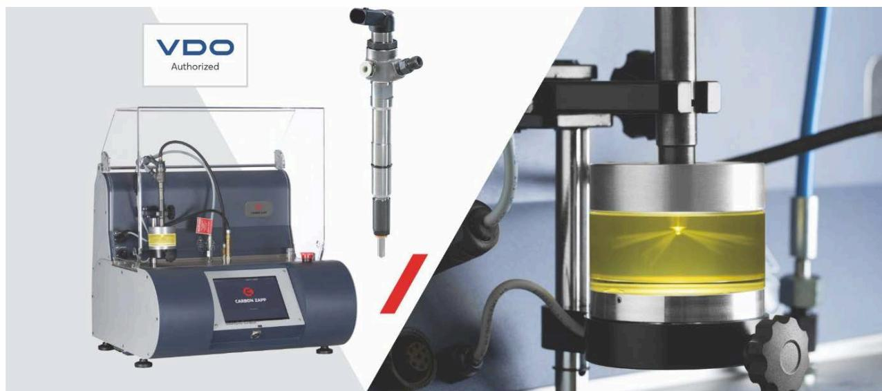
Компания «Carbon Zapp» оптимизировала применение собственных дизельных испытательных установок, позволяя уполномоченным партнерам VDO DRS, оснащенным блоками Carbon Zapp CRU.2R, тоже испытывать, ремонтировать и кодифицировать форсунки системы питания с общей топливной магистралью EU5 под маркой континентального бренда VDO благодаря усовершенствованным испытательным способностям установки управлять форсунками в связи с внедрением сигнализации контроля энергопотребления.
