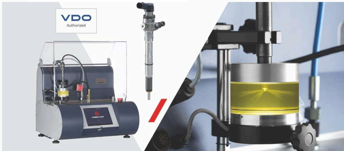
Carbon Zapp ha ottimizzato le applicazioni di test dei suoi banchi di prova diesel, consentendo ora ai partner autorizzati VDO DRS dotati di banco CRU.2R di Carbon Zapp di testare, riparare e codificare gli iniettori Common-Rail EU5 dal marchio Continental VDO grazie alle avanzate funzionalità di test del banco per controllare gli iniettori implementando il segnale Energetico Controllato.
